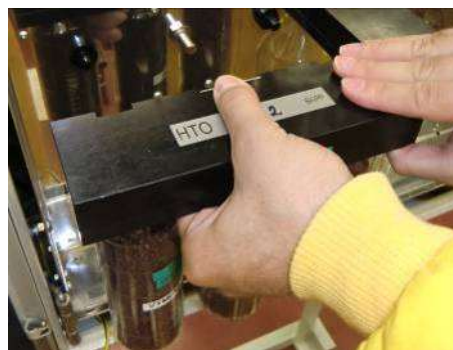
Vložení kazety s odběrovými nádobami se silikagelem
