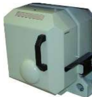
Stíněná vyhřívávací komora s filtry a detektorem dávkového příkonu
